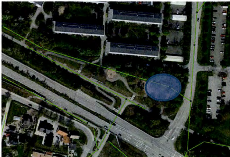
Läge på dagvattenledning i den allmänna parken. Blå yta visar möjlig lokalisering av öppen anläggning.
