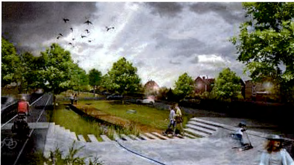
Bild 1: Yta i gaturummet där vatten kan hanteras och transporteras vid kraftiga regn (Illustration: Envidan/Gruppe).
