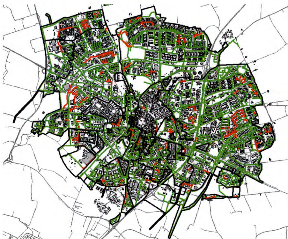
Figur 4: Röda markeringar visar överbelastade dagvattenledningar vid ett 10-årsregn.
